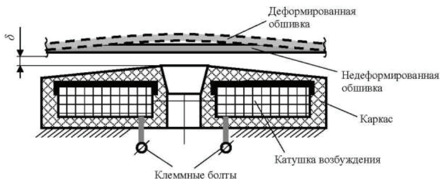
Рис. 4.4. Схема работы электроимпульсной ПОС
