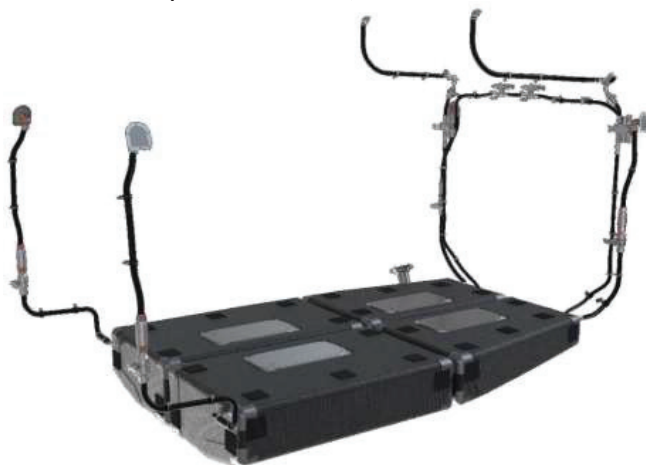
Рис. 3.32. Авариестойкая топливная система вертолета холдинга «Технодинамика»
