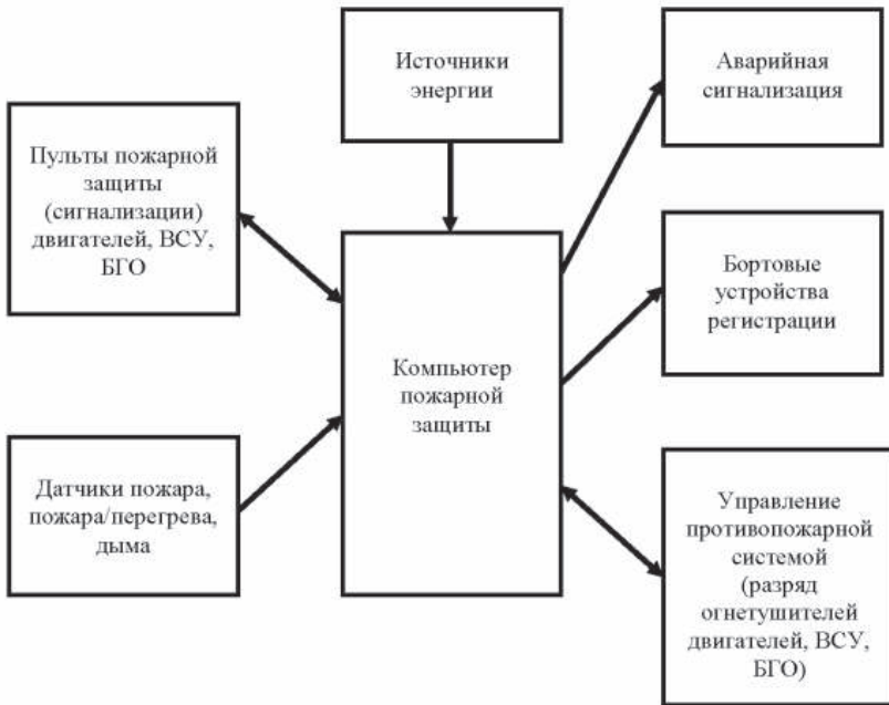
Рис. 5.1. Типовая функциональная схема ППС самолета
