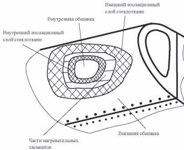
Рис. 4.11. Принципиальная схема ПОС оперения
