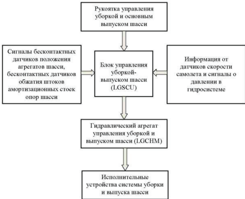
Рис.1.24. Блок-схема системы управления уборкой-выпуском шасси самолета Суперджет
