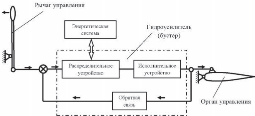
Рис.1.11. Принципиальная схема бустерного управления
